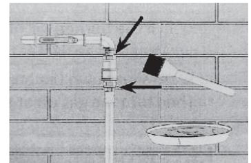
1. Préparez de 65 à 95 ml de solution pour l'essai d'étanchéité (une part de liquide à vaisselle pour trois parts d'eau).
