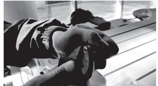
6. Insérez l'embout connecteur dans l'obturateur d'air. Rattachez le tuyau flexible. Serrez à l'aide de la clé à molette.
